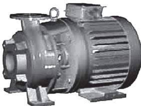
Перекачиваемая среда: вода питьевая и промышленно-хозяйственного назначения с содержанием механических примесей не более 0,1 % по объему, размером не более 0,2 мм, с температурой от 0 до +105 °C, а также других жидкостей, сходных с водой по плотности, вязкости и химической активности. Уплотнение вала одинарное торцевое в марке индекс «5».
