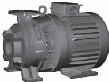
Насосы типа КМ — центробежные, консольные, моноблочные, одноступенчатые с односторонним подводом жидкости к рабочему колесу.
