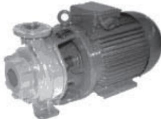
Перекачиваемая среда: для перекачивания слабо-агрессивных и нейтральных жидкостей, не содержащих механических примесей с водородным показателем pH 5...10, плотностью до 1250 кг/м<sup>3</sup> (питьевая вода, спирт, вино, пиво, соки, хим. реагенты), температурой до + 140 °C (по исполнению) в пищевой и других отраслях промышленности. Применение насоса для перекачивания жидкости с температурой +140 °C оговаривается при заказе.
